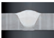
Prima passata con IAC® in verticale discendente su 10 mm di acciaio dolce; riempita con due passate con l'uso della funzione Sequenza
