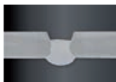
Prima passata con IAC® in verticale discendente su 5 mm di acciaio dolce
