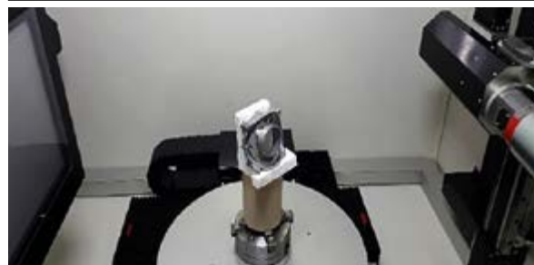
Fig. 16: Sistema Gilardoni SCOPIX CT HP7 225 kV con manipolatore di precisione a 7 assi con tavola rotante
