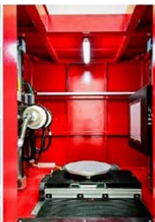
Fig. 17: Cabina con dimensioni: H 2650 mm, P 2310 mm, L 2810 mm. Impianto Gilardoni XE-L HE 450 kV per radioscopia e tomografia difettoscopica
