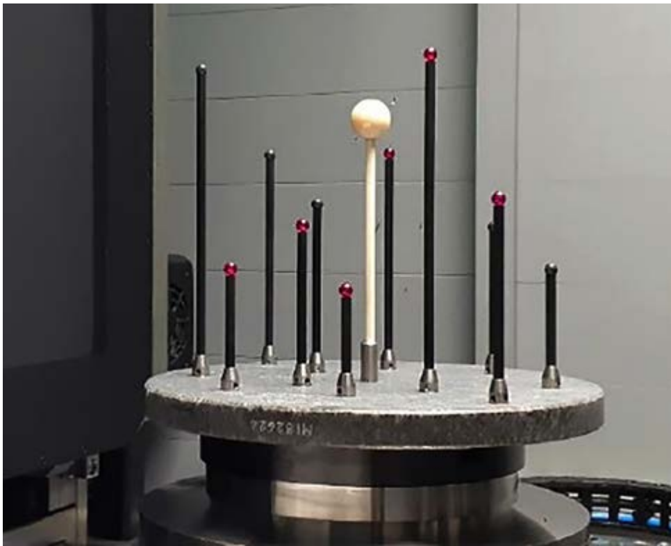
Fig. 25: Artefatto a sfere di rubino per il controllo della calibrazione metrologica del tomografo Wenzel Exa CT U 300 di AQM srl
