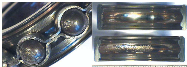
Figura 4.28. Tipica morfologia della fatica da contatto che ha portato alla scheggiatura delle sfere e della ralla esterna di un cuscinetto volvente.
