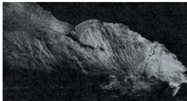
Figura 15.41. Superficie di frattura di un generatore di vapore danneggiato. La morfologia della frattura è tipica della fatica. L'innesco è sulla superficie interna in corrispondenza di un punto di corrosione.
