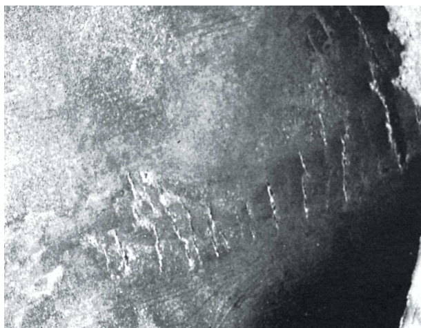
Figura 15.34. Cricche sulla parete interna della zona più aperta del particolare scoppiato. 1 x circa.
